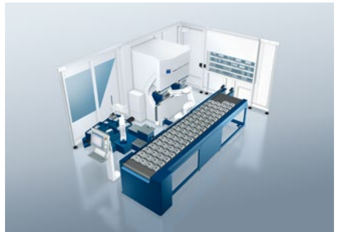
TruBend Cell 7000 mit BendMaster (15), LoadMaster, ToolMaster und Förderband.
