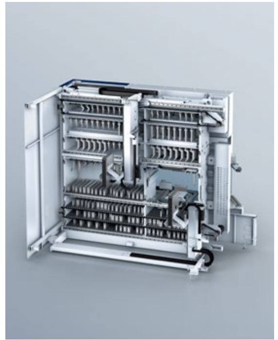
Der ToolMaster verwendet Standardwerkzeuge, zudem können Sie ACB- und Sonderwerkzeuge sowie Werkzeuge mit Adapter nutzen.
