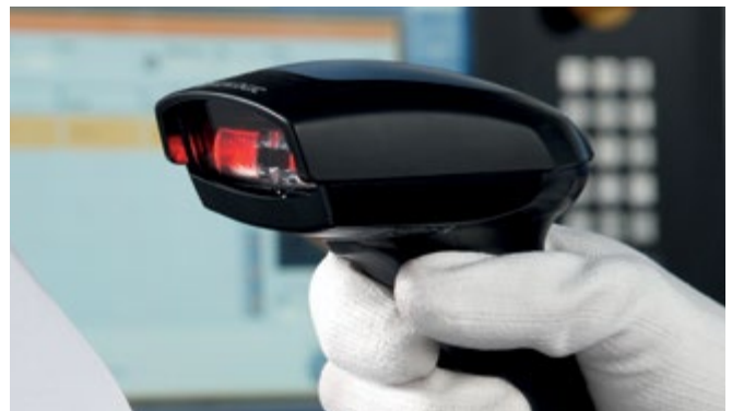
Mithilfe des 2D-Code-Scanners rufen Sie Programme einfach auf.
