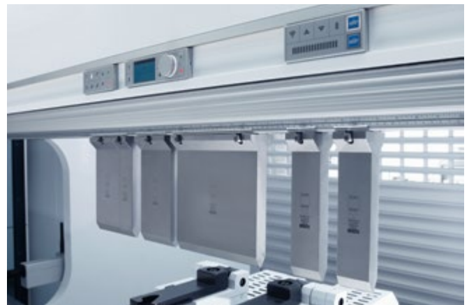
Der Tool Indicator zeigt beim Rüsten genau, wo die Biegewerkzeuge eingesetzt werden müssen.
