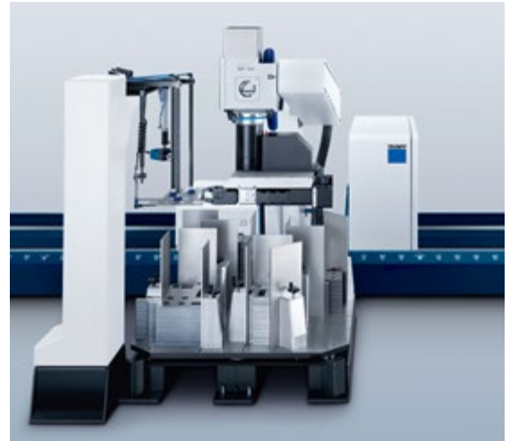
Blechentnahmestation mit Drehtisch
